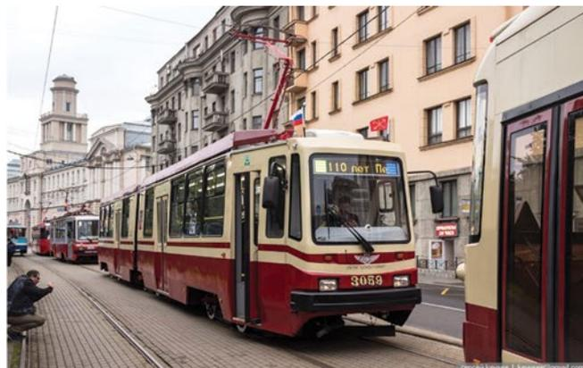
Рис. 3. Модернизированный трамвай ЛВС86-М2
