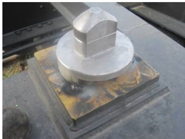
Рис. 8. Упор фитинговый поворотный [20]
