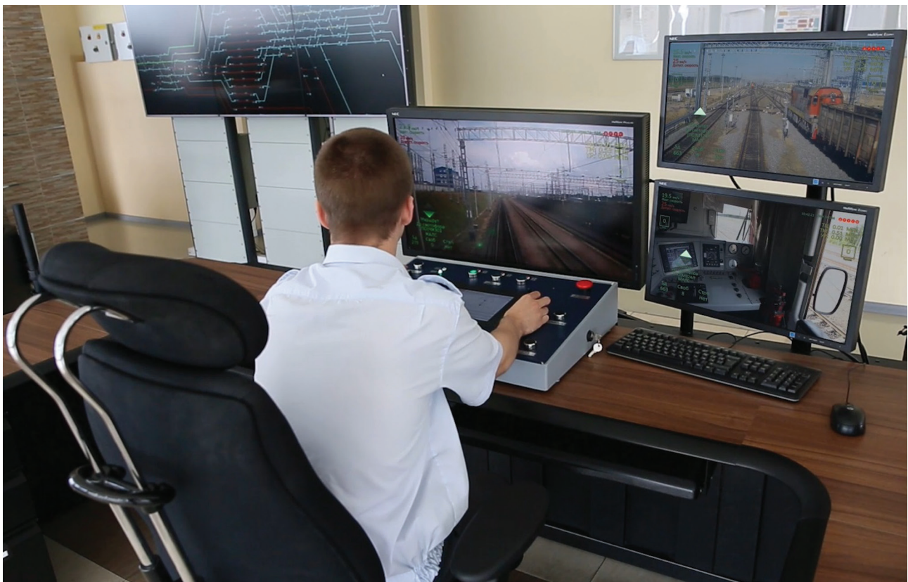
Рис. 3. Стационарный пульт управления и контроля беспилотными локомотивами на станции Лужская 5
