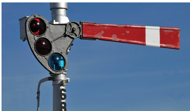
Рис. 1. Семафор английской системы сигнализации
