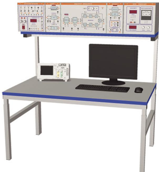
Рис. 1. Стенд для изучения основ теории электрической связи
