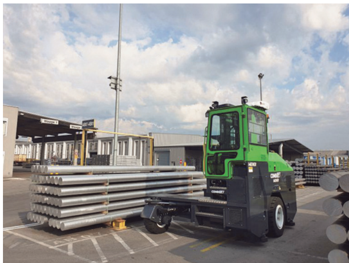
Рис. 3. Вилочный погрузчик с боковым расположением грузовой мачты
