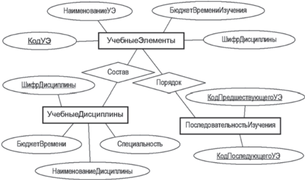
Рис. 4. Фрагмент инфологической модели БД АИСУП на языке ER-диаграмм, ключевые поля выделены подчеркиванием
