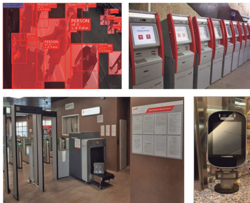
Рис. 2. Локальные элементы перехода на цифровые технологии: контроль загруженности очередей, билетопечатающий автомат (БПА), досмотровые рамки и рентгено-телевизионная установка, система Face ID
