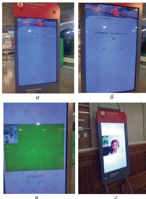
Рис. 2. Фотографии интерфейса видеотерминала и его функционала на вокзальных комплексах ОАО «РЖД» (Ладужский вокзал): а — общий вид терминала (стойки информационно-справочного сопровождения); б — промежуточное подтверждение действия; в — вид при ожидании ответа диспетчера; г — ответ диспетчера (фото авторов)
