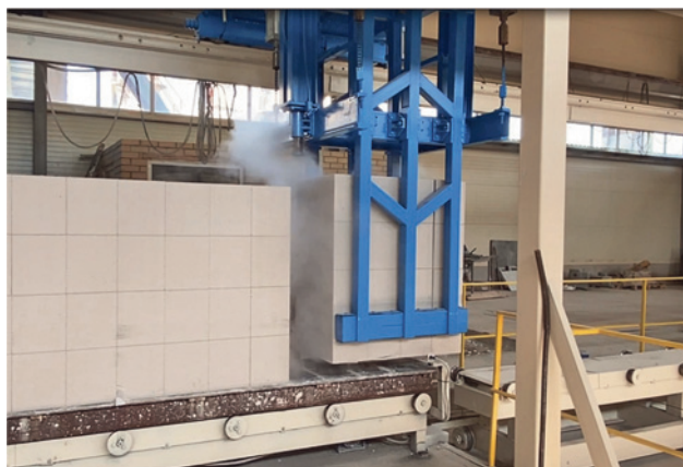
Рис. 8. Пост разборки. Кран-манипулятор с гидравлическими захватами для разборки массива после делительного комплекса
