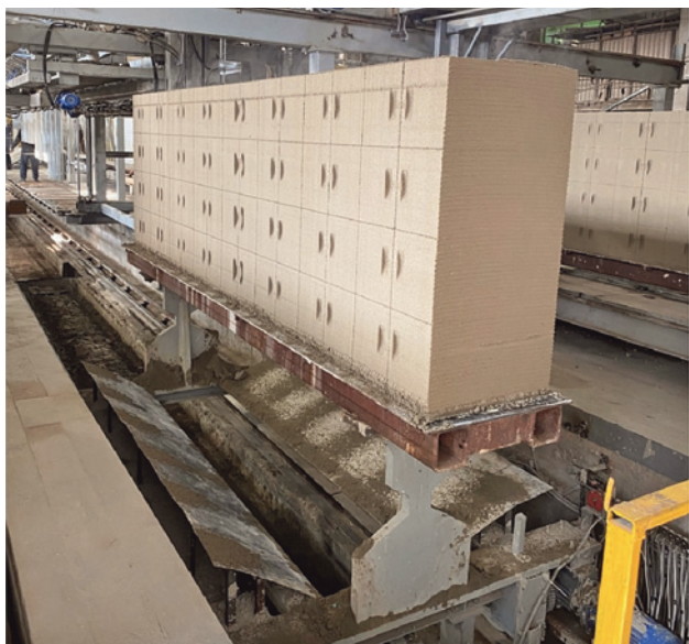
Рис. 7. Транспортировка массивом на каретке резательного комплекса на пост удаления нижнего подрезного слоя
