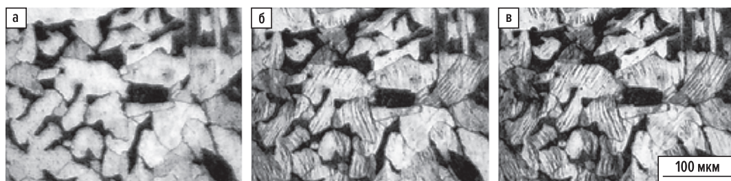
Рис. 3. Металлическая поверхность образца: а — до испытаний; б — после 10^3 циклов нагружения; в — после 2 \cdot 10^3 циклов нагружения
