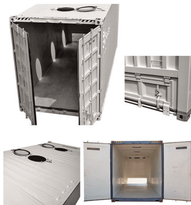
Рис. 7. Внешний вид и элементы специализированного 20-футового контейнера для сыпучих грузов
