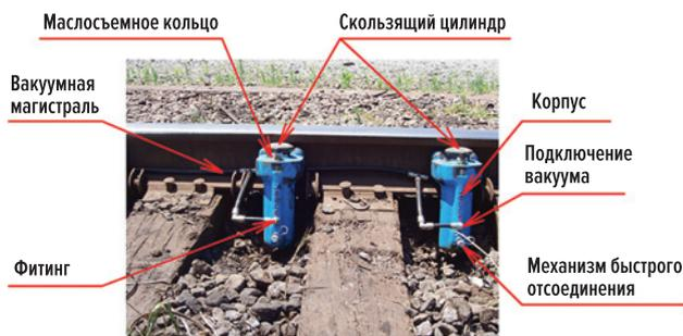
Рис. 3. Домкратовидное устройство закрепления подвижного состава
