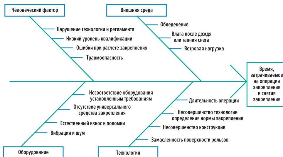
Рис. 4. Схема причинно-следственных связей времени, затрачиваемого на операции закрепления и снятия закрепления (диаграмма Исикавы)
