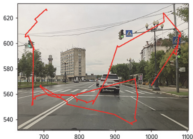
Рис. 4. Направление взгляда водителя в анализируемый момент времени
