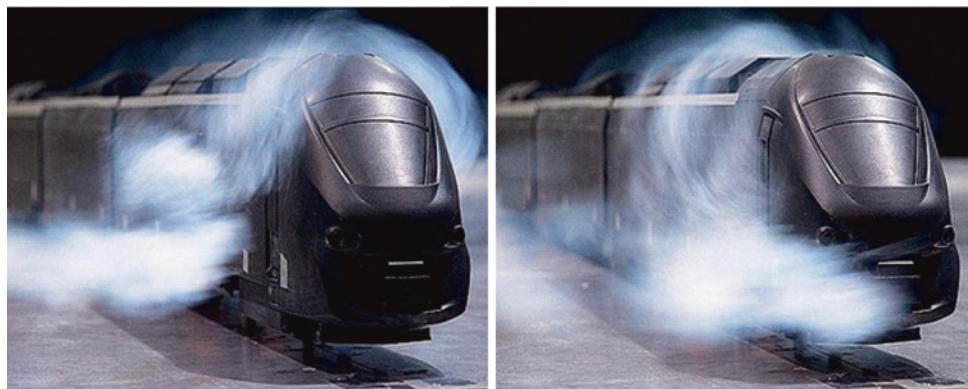
Рис. 1. Масштабная модель 1:15 TGV Duplex в рабочей камере аэродинамической трубы (Франция) [2]
