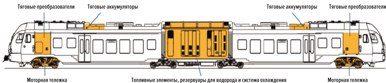
Рис. 2. Устройство водородного поезда
